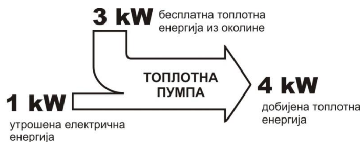
Слика 2.8.4. – Енергетски биланс код коришћења топлотних пумпи
