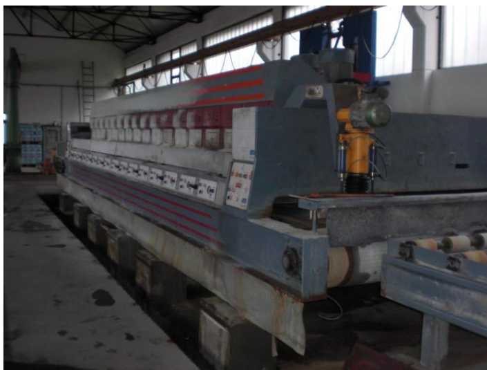
Слика бр.11: Машина за полирање каменних плоча
