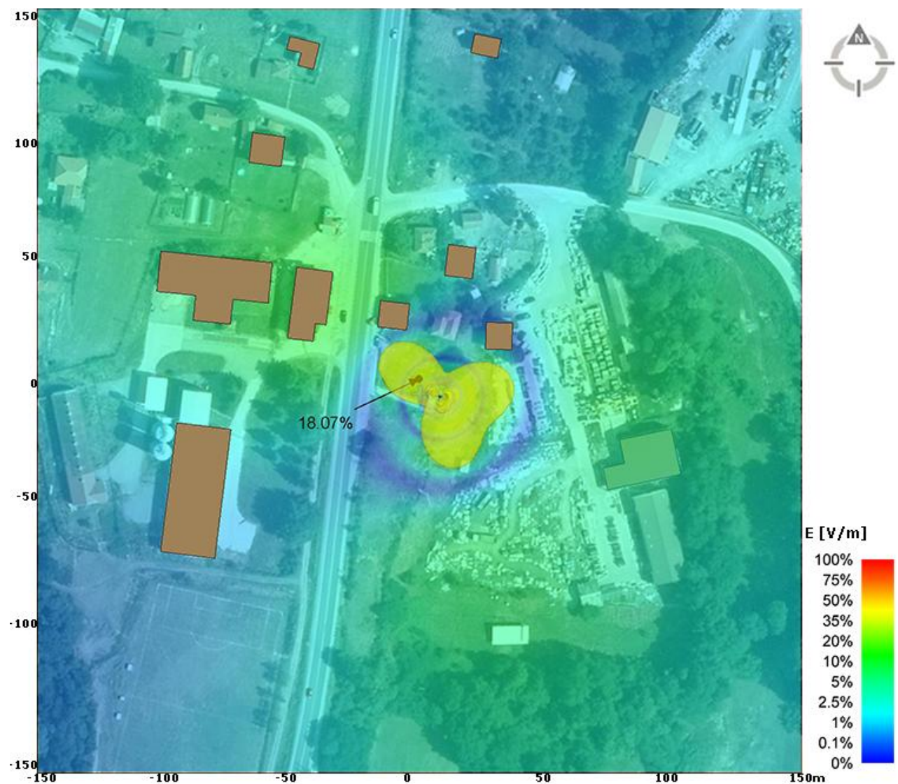
Slika 6.5.4 Rezultati proračuna faktora izloženosti u široj okolini na nivou tla, na visini +1,7m, zaslužaj rada sistema GSM900, UMTS2100 i LTE800 operatera Telekom Srbija, za maksimalno opterećenje.
