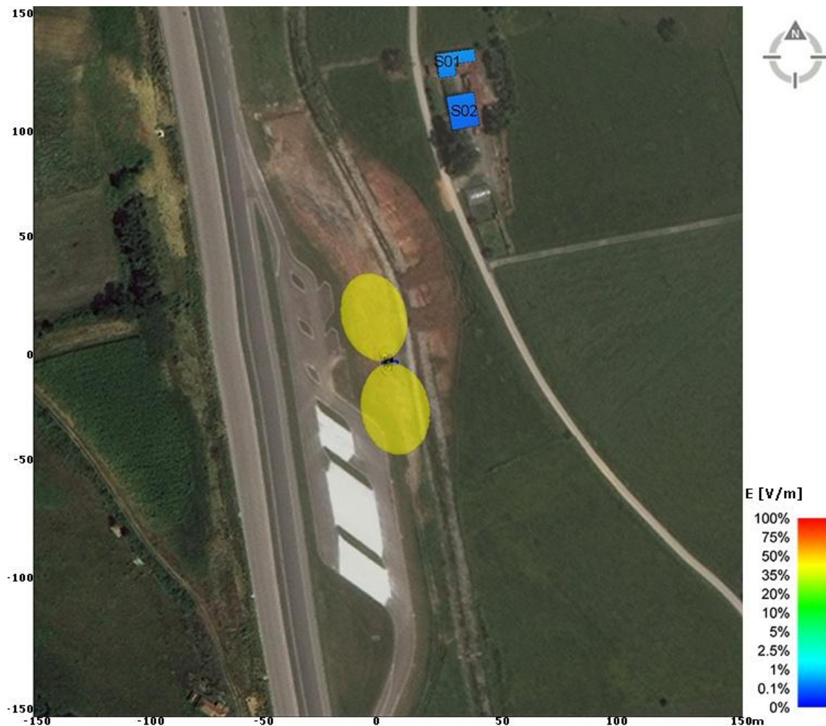
Slika 6.5.10 Rezultati proračuna faktora izloženosti u objektima na najizloženijim spratovima, za slučaj rada sistema UMTS2100, LTE1800 i LTE800 operatera Telekom Srbija i postojeće opterećenje elektromagnetnom emisijom
