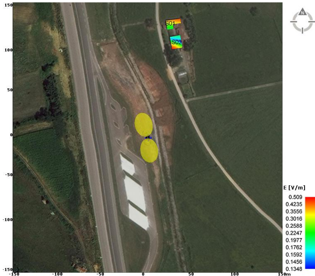
Slika 6.5.7 Rezultati proračuna jačine električnog polja u objektima na najizloženijim spratovima za slučaj rada sistema LTE1800 operatera Telekom Srbija, za maksimalno opterećenje. Maksimum: 0.51 V/m.
