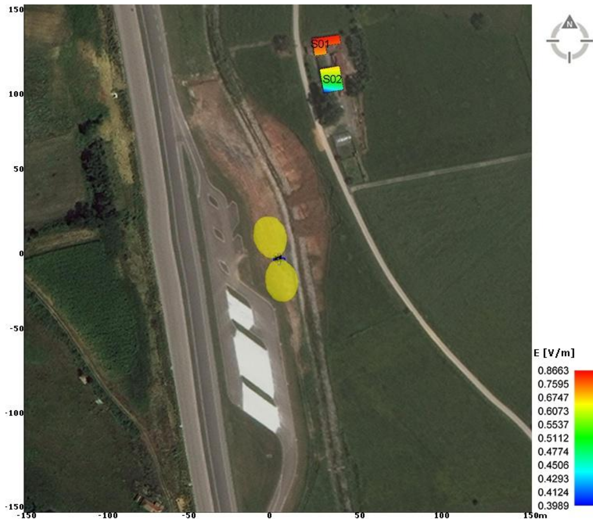
Slika 6.5.8 Rezultati proračuna jačine električnog polja u objektima na najizloženijim spratovima za slučaj rada sistema LTE800 operatera Telekom Srbija, za maksimalno opterećenje. Maksimum: 0.87 V/m.
