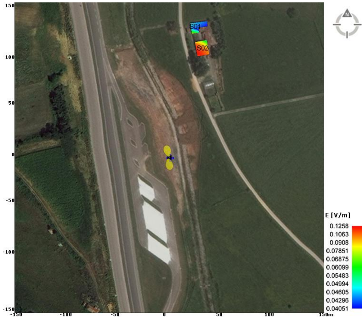
Slika 6.5.6 Rezultati proračuna jačine električnog polja u objektima na najizloženijim spratovima za slučaj rada sistema UMTS2100 operatera Telekom Srbija, za maksimalno opterećenje. Maksimum: 0.13 V/m.
