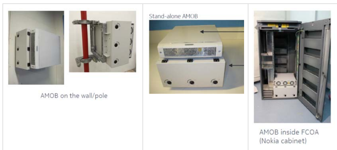
Slika 3.6 AMOB kućište instalacija
