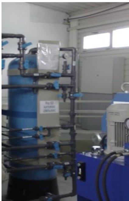
Слика 5. Колона са јоноизмењивачком смолом у постројењу
