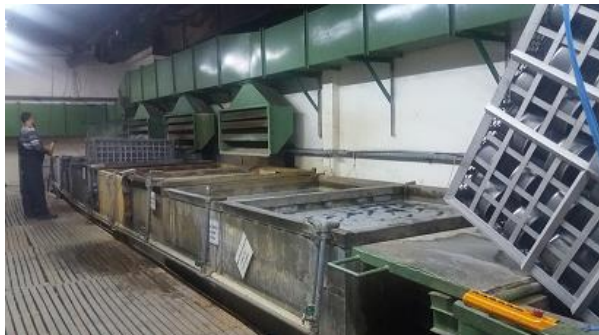
Слика 4. Приказ када у одељењу хемијске припреме металне површине за емајлирање
